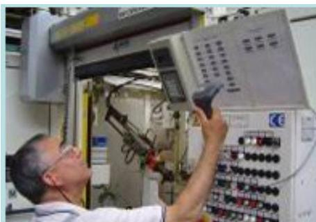
Сформулируем противоречие: терминал нужно крепить под углом, чтобы было лучше видно, и нельзя крепить под углом, т.к. для этого необходимы дополнительные крепящие конструкции. Если на производстве необходимо установить 200 – 300 терминалов, то дополнительные затраты на крепления становятся вполне ощутимыми.
