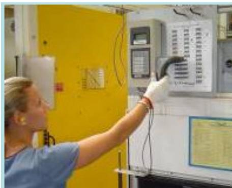
Желательно, чтобы угол зрения и поверхность дисплея находились (в идеале) под углом 90 градусов. Приходится придумывать специальные способы крепления терминала под углом. Именно так поступали на многих предприятиях.
