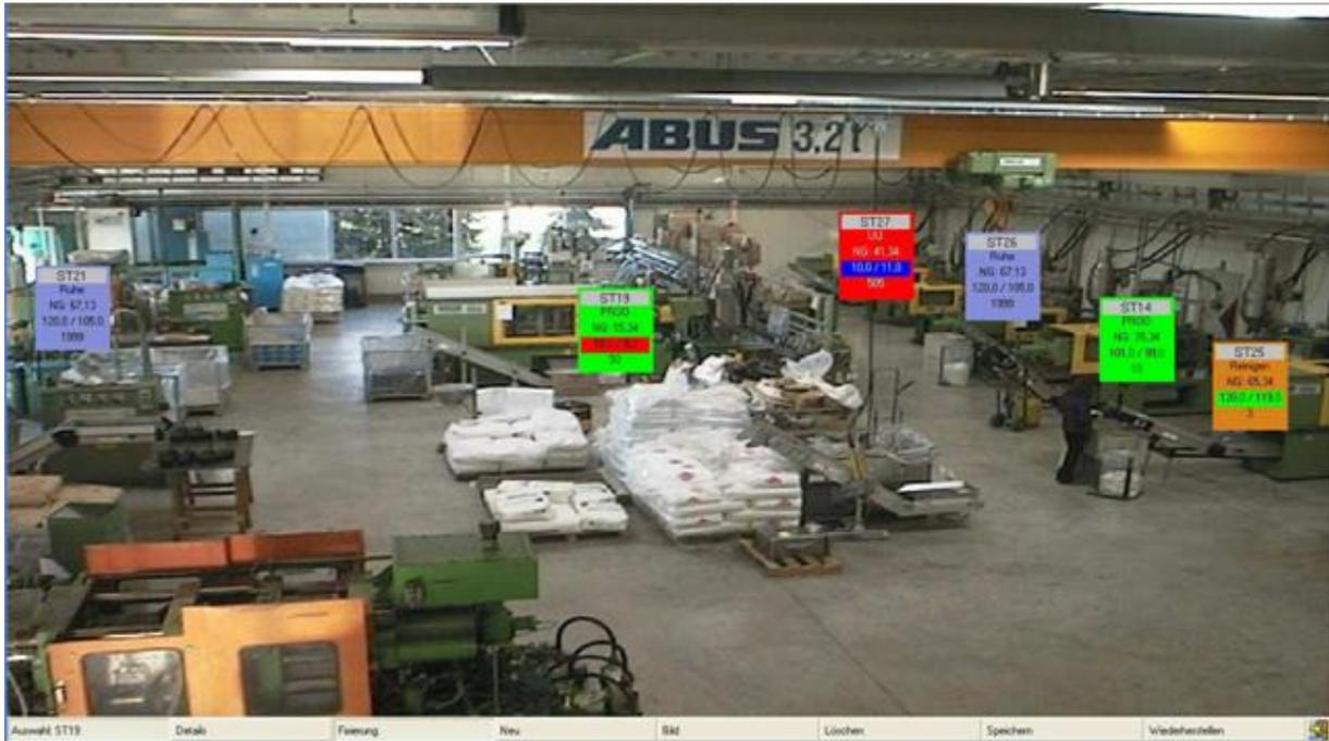
В данном случае мы наблюдаем как бы «дополненную реальность». На изображение цеха накладывается визуальная информация о том, как работает оборудование.
