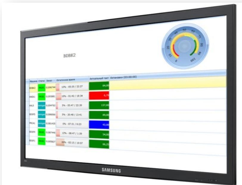
При разрыве соединения с сервером данные перестают обновляться, но изображение не исчезает, вывод данных продолжается в последнем формате сегментации экрана, на экране отображается последний набор загруженных данных, возможна индикация сообщения о разрыве соединения. После восстановления соединения с сервером отображение обновляется в соответствии с планом, сформированным при конфигурировании.
